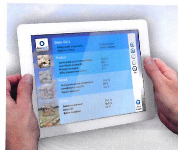
Afb. 2.97 Met een klimaatcomputer kun je de bewaarcondities regelen en de werking van alle machines controleren.
